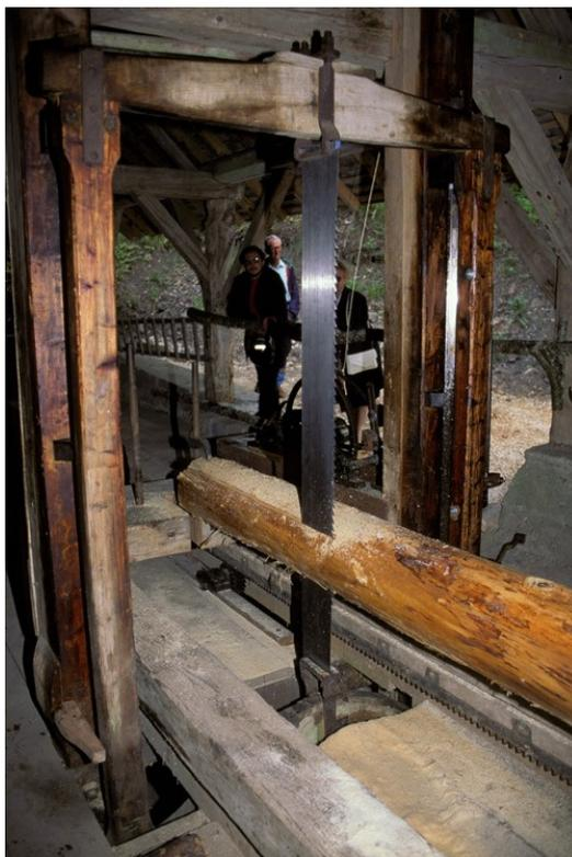
*Scie hydraulique« à grand cadre », à Bellecombe-en-Bauges (73)*
